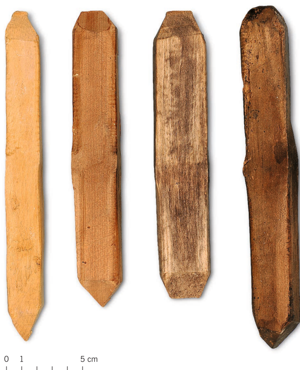
Abb. 26: Dübel aus Kirschbaum-, Buchen- und Eichenholz aus den Häusern Grubenstrasse 37 in Oberägeri (Kat. 11), 1518d, und Artherstrasse 125/127 in Oberwil bei Zug (Kat. 27), 1577d.
