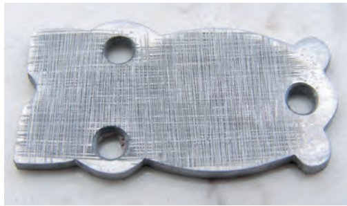
Abb. 430 Das kreuzweise Einritzen von Rillen erzeugt auf der Eisenoberfläche einen rauhen Haftgrund, ähnlich einem Feilenhieb.
