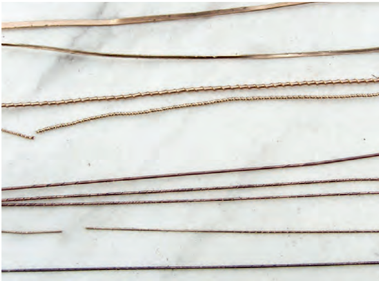
Abb. 429 Herstellungsetappen der Messingdrähte. M. 2:1.
