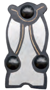
Abb. 445 Tiefschwarze Färbung durch Brünieren im Salzbad. M. 1:1.
