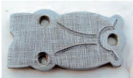
Abb. 431 Vorbereitete Rillen zur Einlage des Messingdrahtes. Ein rauher Grund der Rillen erleichtert die Fixierung der Drahteinlage.
