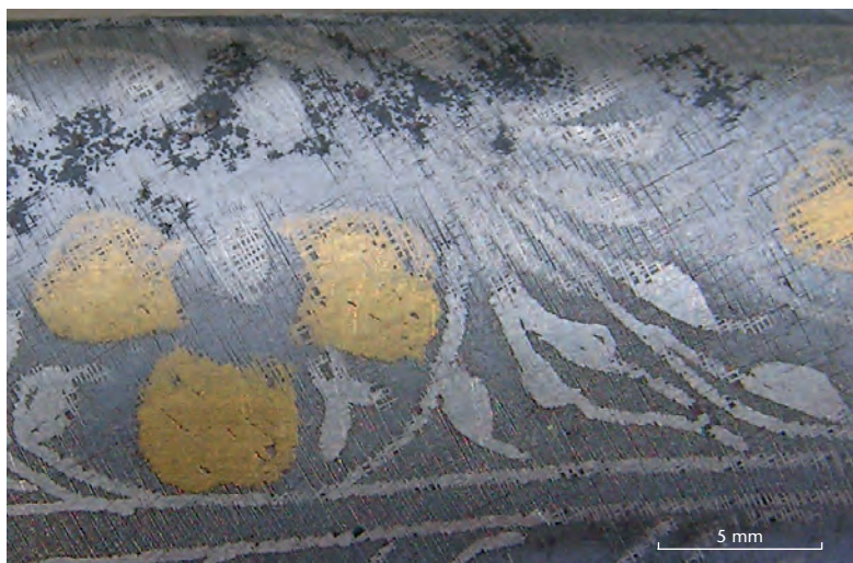
Abb. 427 Abnutzungsmuster der Drahttauschierung beim Griff eines persischen Dolches.
