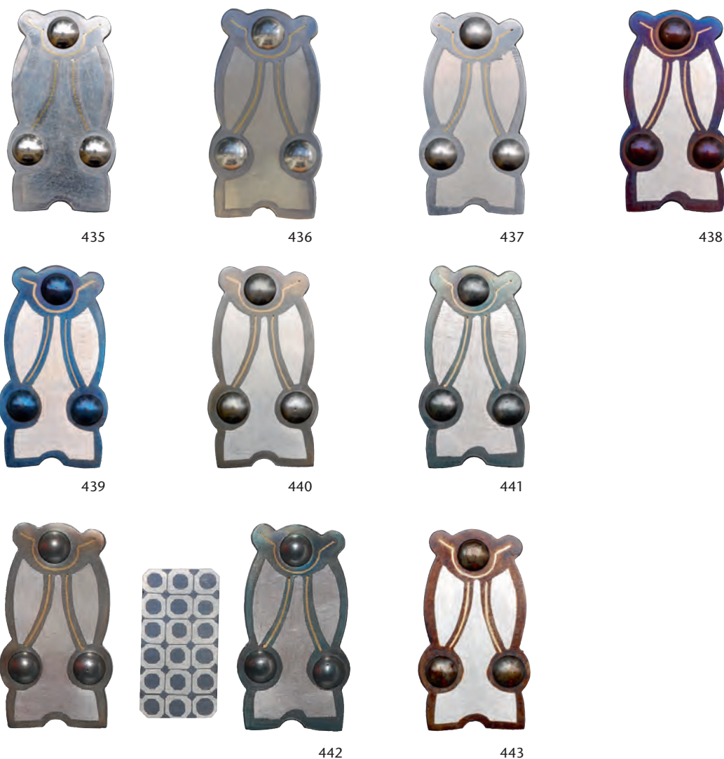
Abb. 435 Glänzende Oberfläche, mit dem Stahl poliert. Aus ungünstigem Winkel betrachtet, verschwinden die Einlagen wegen der Oberflächenreflexion bis zur Unsichtbarkeit.
