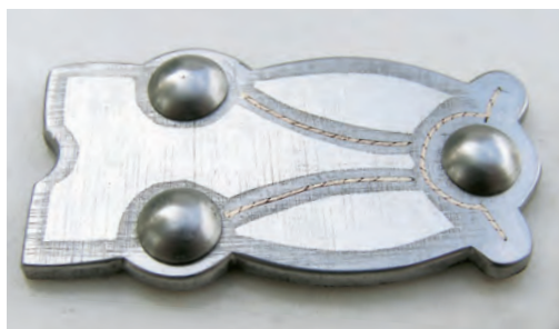
Abb. 434 Das fertige Stück mit eingesetzten Nieten.
