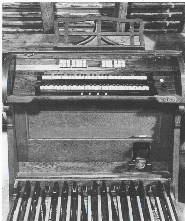
Oberägeri-Morgarten. Kirche St. Vit. Röhrenpneumatischer Spieltisch der Kuhn-Organ von 1916.
