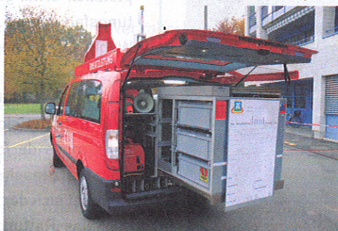
Fahrzeug der Feuerwehr Hünenberg mit praktischem Heckauszug – das Material ist gut verstaut und in Kürze zur Hand.
