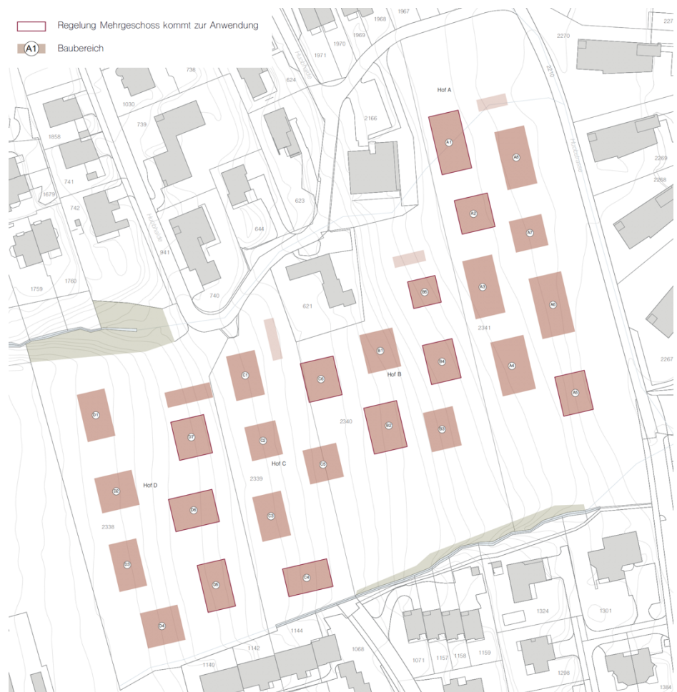
Erläuterungsskizze Regelung Mehrgeschoss (Quelle: KEEAS)
