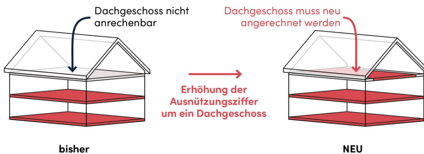
Abb. 7: Änderung der Messweise für Dach- bzw. Attikageschosse, Beispiel der 2-geschossigen Wohnzone (W2b), (Planungsbericht OPR Hünenberg vom 08.08.24, S.48)
