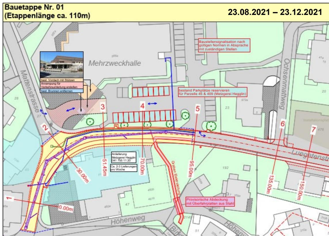
Zurzeit werden die geplanten Bauarbeiten, Neubau einer durchgehende Meteorwasserleitung, die Erneuerung von Werkleitungen, im Bereich Bauetappe Nr. 01 (Rest. Ochsen bis Einmündung Mehrzweckhalle Schützenmatt) ausgeführt. Diese werden bis Ende Oktober 2021 erstellt. Im Anschluss an die Werkleitungsarbeiten werden die Strassen- und Belagsarbeiten, Neubau Randabschlüsse, Einbau Tragschicht realisiert.
