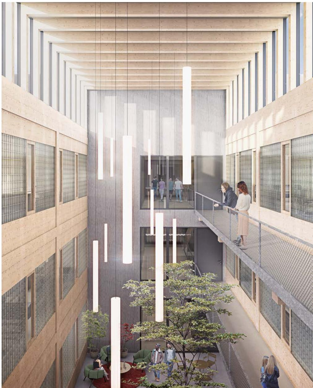
Das Atrium verbindet die drei obersten Geschosse der Mantelnutzung und sorgt für Tageslicht in den innenliegenden Büroräumen. Die beidseitig sichtbare Holzkonstruktion steht im Kontrast zum gegenüberliegenden Betonkern.
