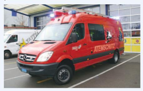
Der Vorteil des Umbaus liegt darin, dass das Verkehrsdienstmaterial auf einem Fahrzeug mitgeführt werden kann und zudem als Transportfahrzeug für sechs Personen Platz bietet. Der Fahrzeuglenker dieses Fahrzeuges benötigt einen Führerausweis Kat. 'B' (bis max. 3.5 t). Der grosse Vorteil dieser Lösung besteht darin, dass mit einem Fahrzeug der Transport des Verkehrsdienstmaterials sowie der zugehörigen Personen des Verkehrsdienstes gewährleistet werden kann.
