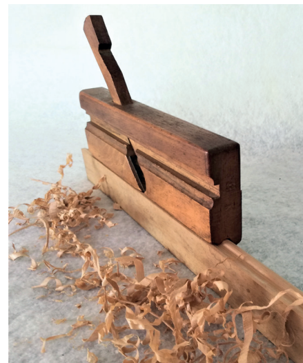
Profilhobel mit den Massen 24,5 x 8 x 3 cm, Hobeisen 18 cm, Keil 15,5 cm, Birnbaum-Holz
