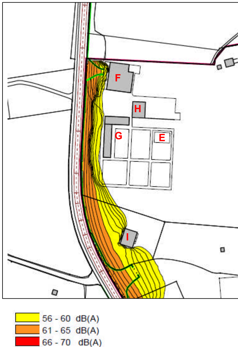
Abbildung 6: Lärmbelastung tags Höhe = 4.5 m ü. Terrain
