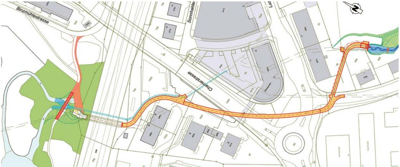
Entlastungsstollen zwischen dem Grundstück Nr. 56 und SBB-Kanal (orange eingefärbt) mit neuer separat geführter Leitung in den Binzmühleweiher (hellblau eingefärbt)
