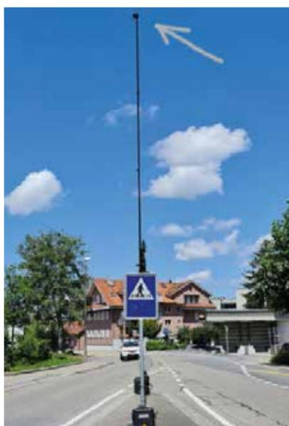
Bildlegende: so sieht eine Zählstation mit Kamera aus. Bild: Swisstraffic AG
