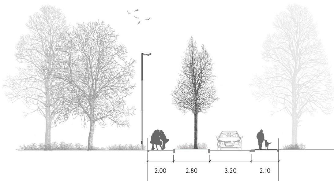
Abbildung 14: Querschnitt der Grabenackerstrasse
