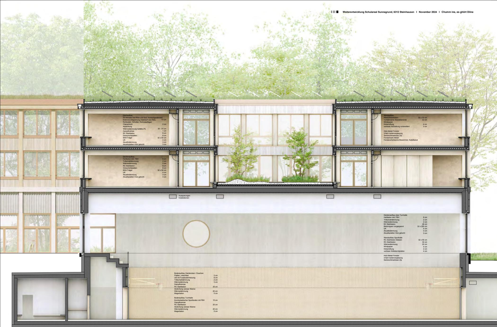
Konstruktionsschnitt mit Innenansicht und Fassadenschnitt
