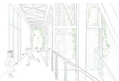
Aussenerschliessung mit ReUse der alten Stahlträger
