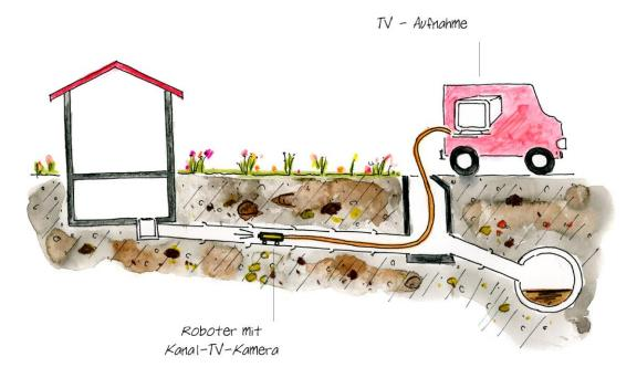
Sind die Entwässerungsanlagen Ihrer Liegenschaft seit längerer Zeit in Betrieb, ist es sinnvoll, den Zustand der Anlagen - nach vorgängiger Reinigung - durch erfahrene Spezialfirmen für Kanalfernsehen begutachten zu lassen. Die Zustandsaufnahmen der Leitungen im Untergrund sollten regelmässig (mind. alle 15 Jahre) erfolgen. Dieses Vorgehen verschont Sie vor unangenehmen Überraschungen.
