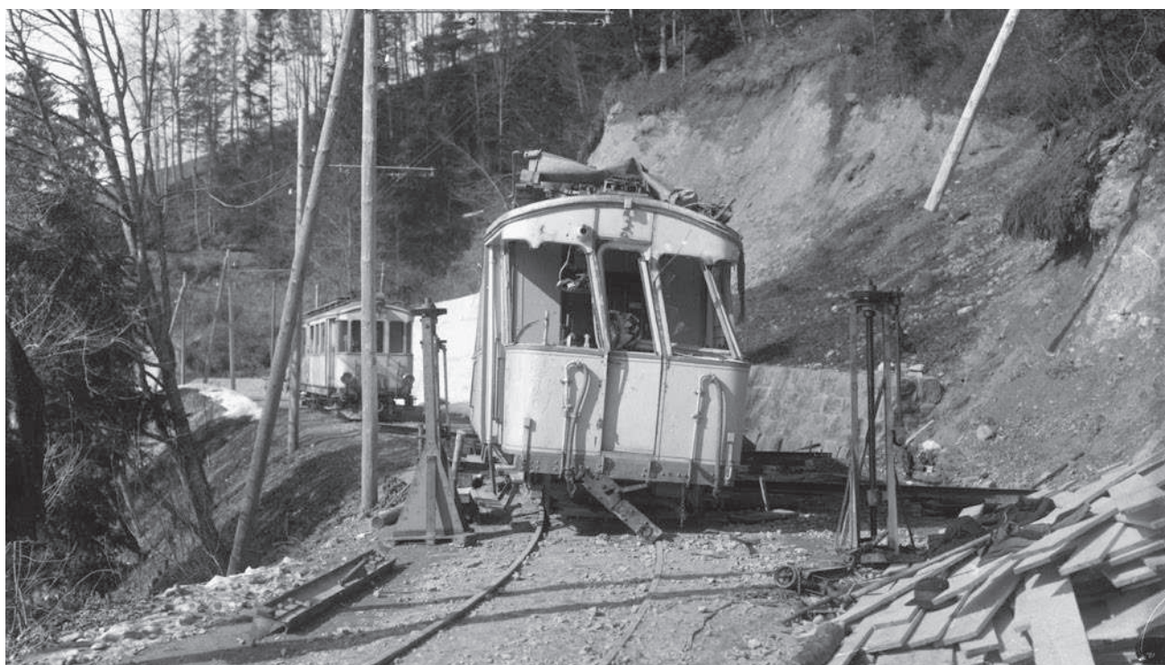
Güterzug der ESZ, der bei der Lorzentobelbrücke entgleiste – was bei diesen Schienen nicht erstaunt, 1920er Jahre (Bild: Staatsarchiv Zug)
