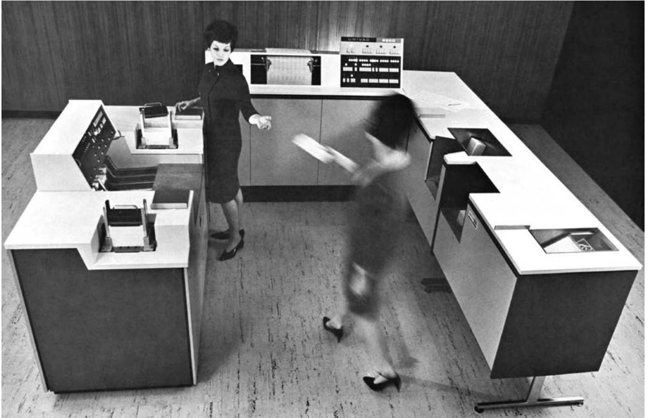
Dieser Computer, Typ UNIVAC 9200, mit 8 Kilobytes Speicher nahm im Mai 1970 im Verwaltungsgebäude am Postplatz seinen Betrieb auf. Der Speicherplatz eines modernen Smartphones (32 Gigabyte) ist ca. 4 Millionen mal grösser.
