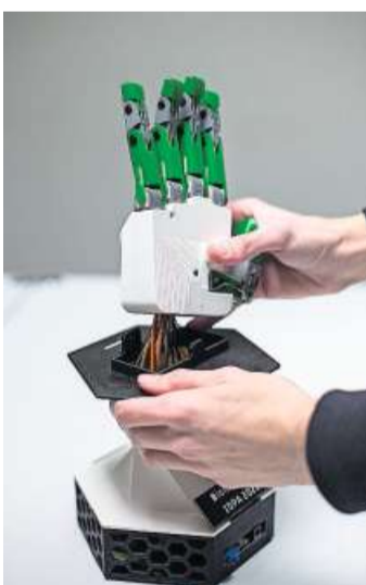
Sämtliche Kunststoffteile der bionischen Hand wurden mit dem 3D-Drucker hergestellt.
