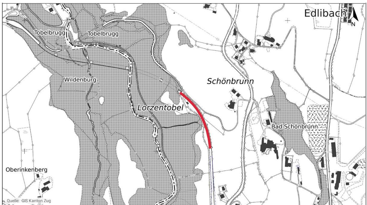
Auf dem rot markierten Bereich zwischen der Lorzentobelbrücke und Nidfuren wird ein neuer Deckbelag eingebaut.
