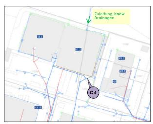
Abb. 6: Die Zusatzmessstelle C4 in der Gewerbezone Bösch liegt beim Anschluss der Drainagenleitung aus dem Landwirtschaftsgebiet zwischen Schlössli und Schmalholz
